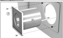
Setzen Sie nun das Freischaltelement FSE Typ PZ 6 von vorne auf die Aufnahme und verschrauben Sie es mit den beiliegenden kurzen Senkschrauben M 4 x 6 mm 7.
