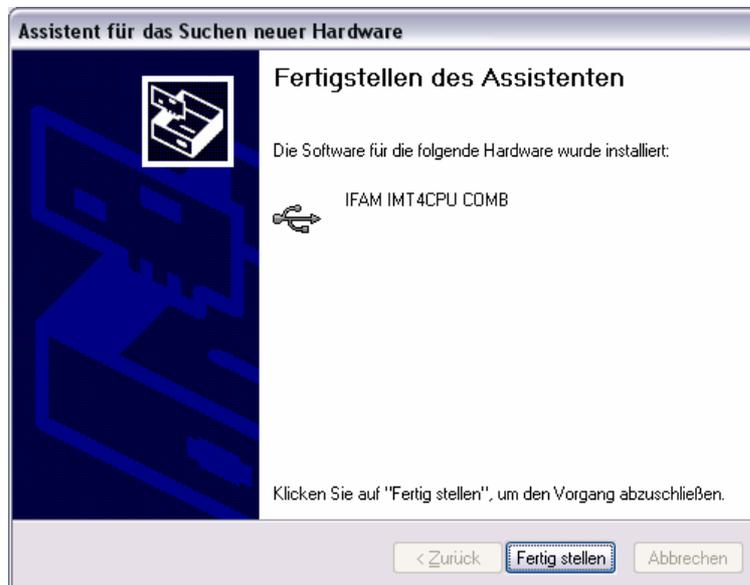
Der Treiber für das USB-Gerät ist nun installiert. Es geht automatisch weiter mit der Installation eines virtuellen COM-Ports. Diese COM-Schnittstelle wird zur Programmierung benötigt.
