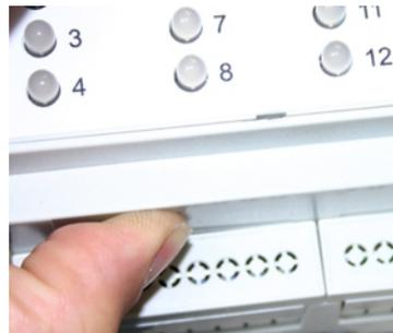
Sind alle Kabel angeschlossen setzen Sie die Abdeckungen wieder ein. Entfernen Sie vorher die überflüssigen Stege.
