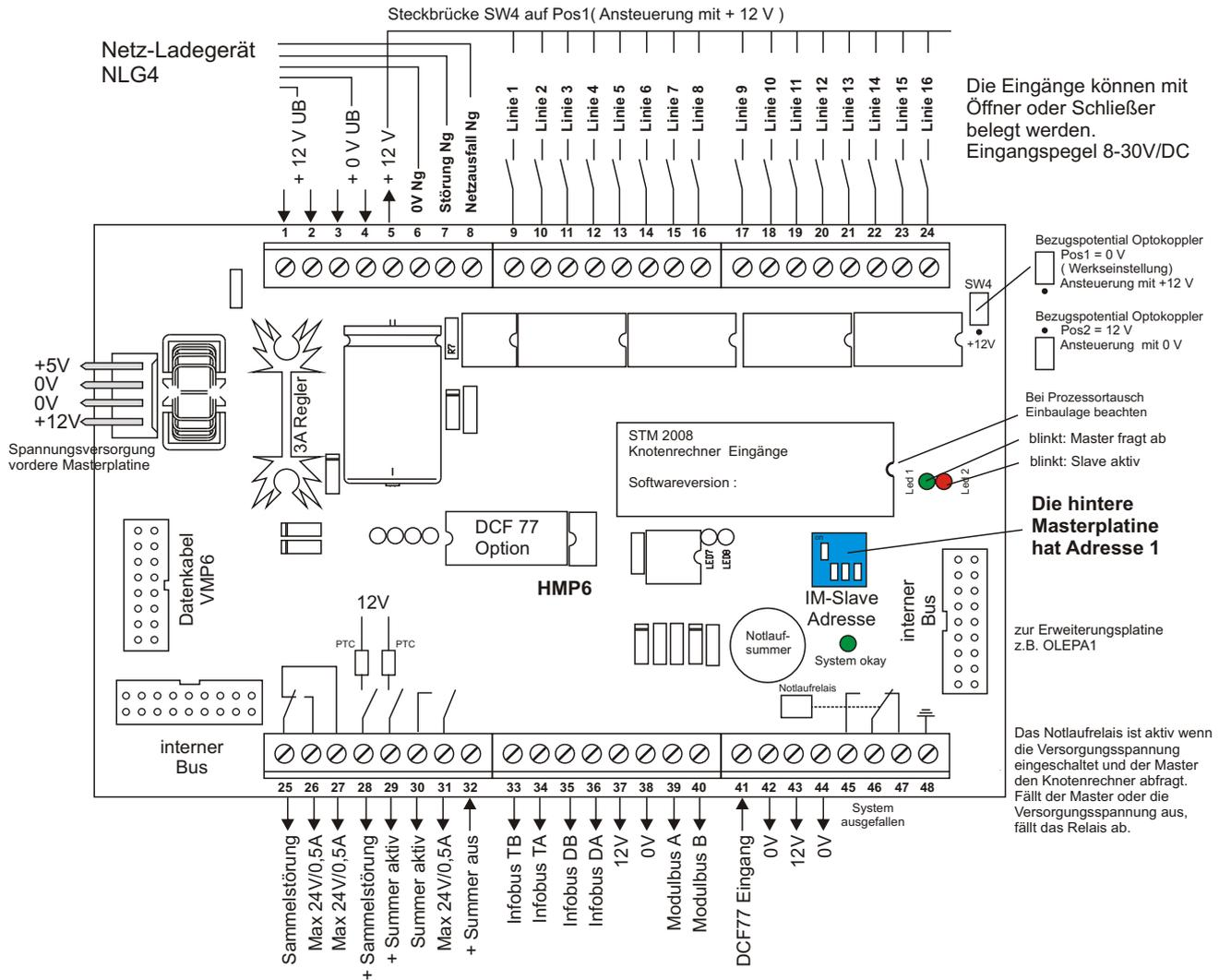
Die hintere Masterplatine versorgt alle Module des STM 2008 Systems mit 5 V. Dazu befindet sich auf der Platine ein Schaltreglerbaustein der Spitzenströme bis drei Ampere liefern kann. Die vordere Masterplatine VMP 6 wird über ein vierpoliges Kabel mit den Betriebsspannungen versorgt. Alle anderen Module erhalten Ihre Energie über den internen Bus.
