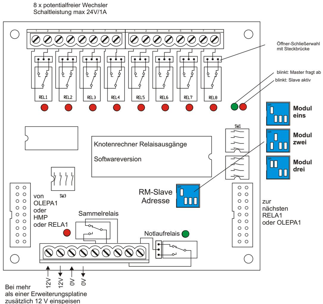
Mit dem Relaismodul RELA1 wird das Störmeldesystem STM 2008 um ein Ausgabemodul erweitert. Es stehen pro Modul acht Relais mit jeweils einem potentialfreiem Kontakt zur Verfügung. Die Kontaktausführung Öffner oder Schließer wird über eine Steckbrücke eingestellt. Bei Betriebsmeldungen bleibt das Relais aktiviert, solange das Eingangssignal anliegt. Bei Störmeldungen bleibt das Relais bis zum löschen des Speichers aktiviert.
