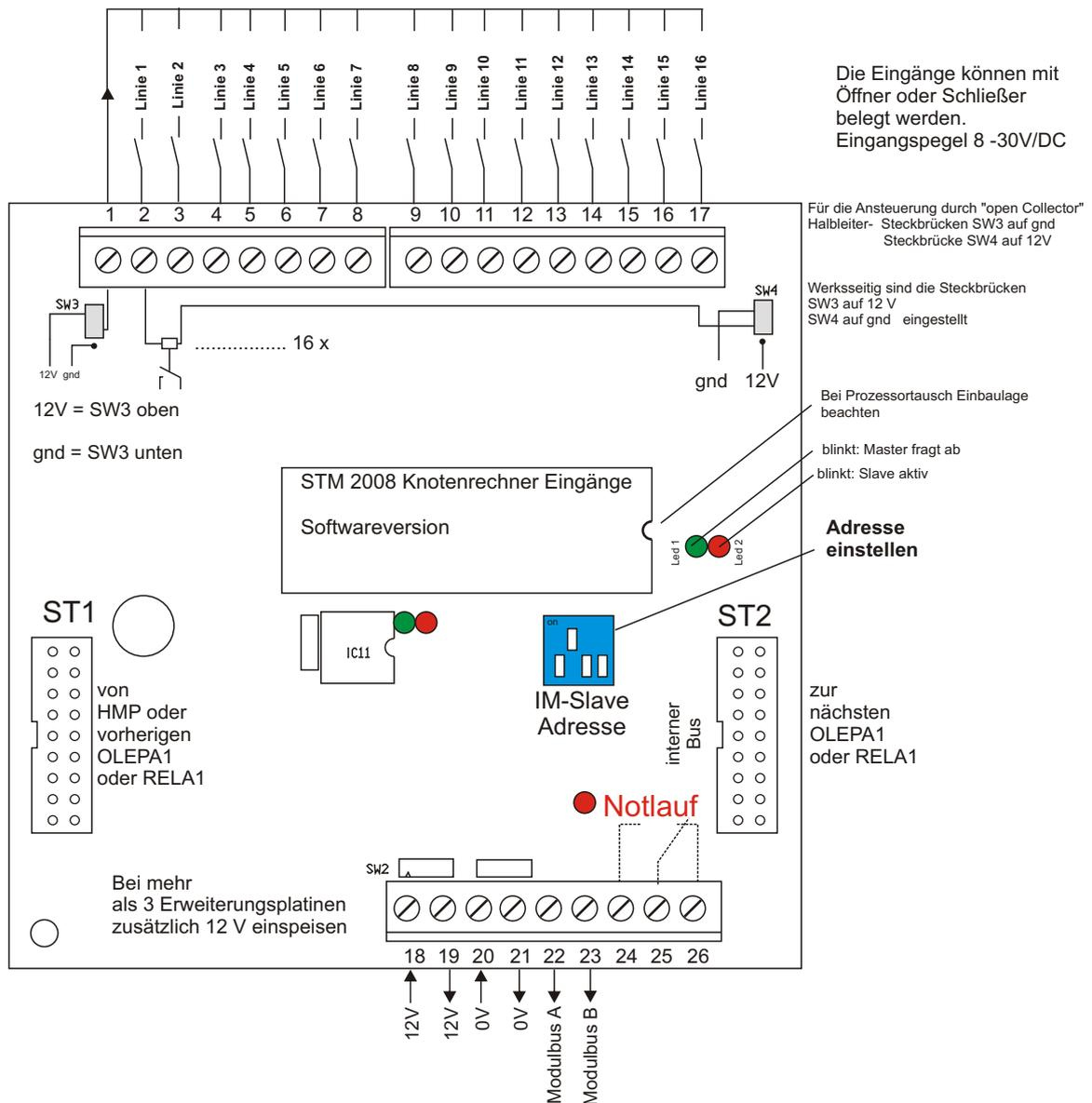
Mit der Linienkarte OLEPA1 wird das Störmeldesystem STM 2008-64 um jeweils 16 optoentkoppelte Meldelinien erweitert. Damit die vordere Masterplatine die Karte erkennen kann, ist die Adresse wie folgt einzustellen :
