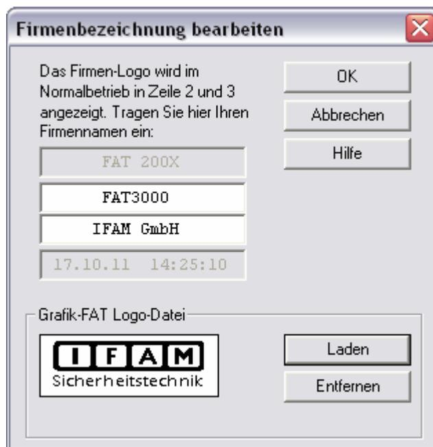
Die 1. Zeile bleibt standardmäßig leer. Bei erkannter Störung der Kommunikation zur BMZ wird hier eine entsprechende Störungsmeldung angezeigt. Die 4. Zeile enthält Datum und Uhrzeit.
